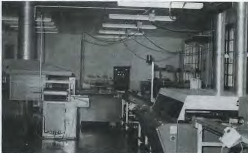
Système de décontamination des cartes après sondage à la vague.
