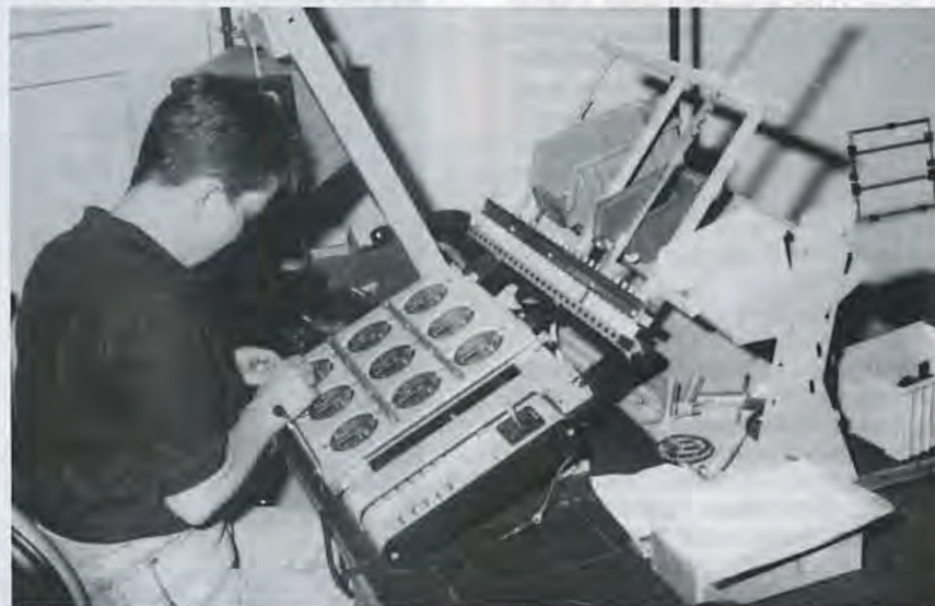
Toronnage et câblage. Boîtier de jonction n°1 (BJ1). AMX30B2
